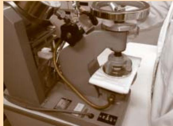
トイレトーパー破裂試験機による検査
