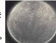
一部皮膜がはがれた状態
